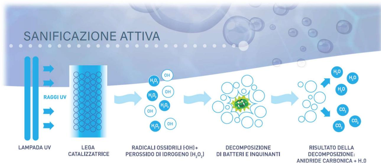
Diffuso e trascinato dal flusso dell'aria il perossido d'idrogeno ( $H_2O_2$ ) rende efficace la sua azione di sanificazione sia sulle superfici dei condotti, sia nell'aria dell'ambiente e per contatto anche sulle superfici dei locali trattati.
