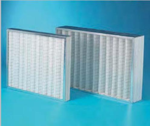
Cella filtrante ondulata sintetica con telaio sezione ad U in acciaio zincato, doppia rete ondulata in filo zincato elettrosaldato che supporta il tessuto filtrante in fibra sintetica di poliestere serie AT200 in fiocco termolegante con grammatura di 200 gr/m<sup>2</sup> e spessore di 20 mm.
