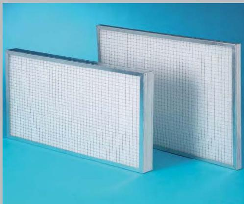
Cella filtrante piana sintetica con telaio sezione ad U in acciaio zincato, doppia rete in filo zincato elettrosaldato che supporta il tessuto filtrante in fibra sintetica di poliestere serie AT150 in fiocco termolegante con grammatura di 150 gr/m<sup>2</sup> e spessore di 14-16 mm.
