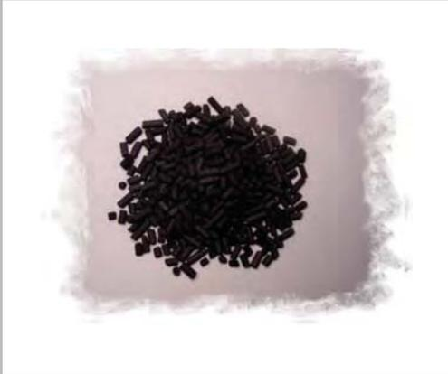
Carbone attivo granulare di origine vegetale attivato fisicamente.
