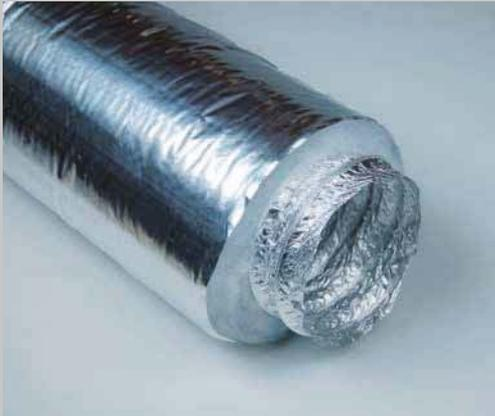
Condotta flessibile realizzata con parete in AL/PET/AL (alluminio/poliestere/alluminio) e spirale in filo di acciaio armonico. Rivestimento termoisolante in fibra di poliestere (sp. 25mm/16kg/m<sup>3</sup>). Protezione esterna in film poliolefinico alluminato (flame retardant). La robustezza della fibra di poliestere termolegata evita la dispersione delle microfibre durante il passaggio dell'aria.
